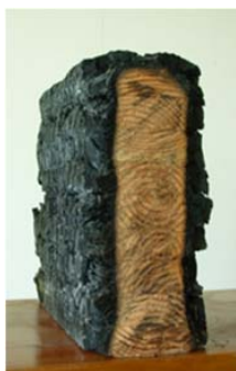
圖9.3-9 木材燃燒炭化深度示意圖
